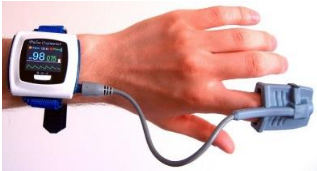
شكل (4) مقياس التأكسج oximeter مثبت بجهاز استشعار عن بعد ومثبت حول المعصم.
