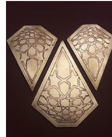
شكل رقم (18) تنفيذ التشكيل الزخرفى بالحفر الحمضى
