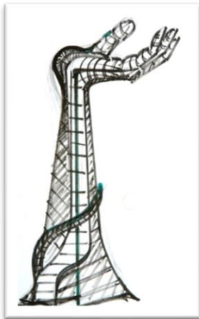
شكل (1) نموذج خطي يمثل الهيكل الاساسي للتمثال ينفذ بالحديد
